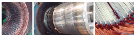
Figura 5. Daños típicos en núcleos laminados.
