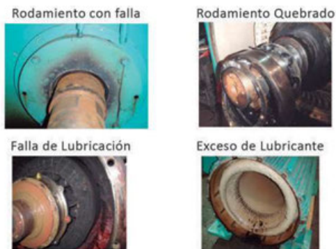
Figura 5. Fallas mecánicas en aerogeneradores.
