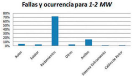
Figura 3. Fallas más comunes en aerogeneradores 1 a 2 MW.
